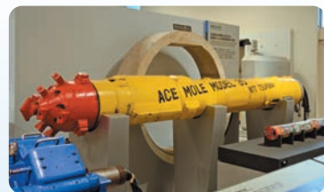
管路を掘削するための機械
