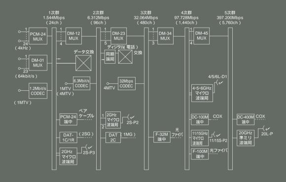
高速大容量の伝送路が開発されるに従い、より高次の多重化装置も開発されていく。
