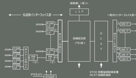
注)1.5Mインタフェース部ではハードウェア構成が容易ないように、1.5M4本を多重化し8.192Mbpsに変換している。
