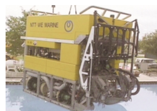
海底ケーブル修理調査用ロボット CARBIS
