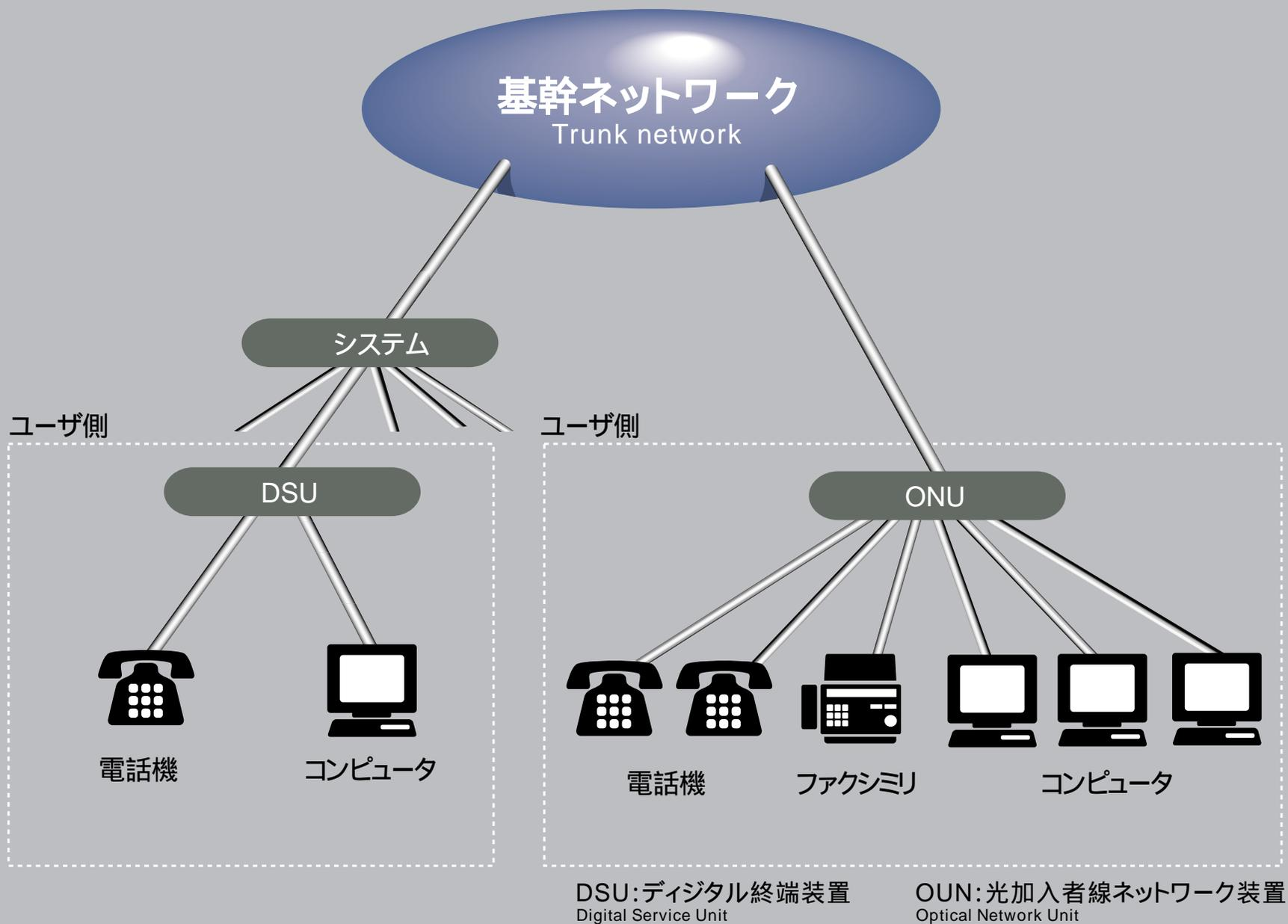
アクセスライン:( 幹線部 )光ケーブル( 分岐部 )光ケーブル/メタリック多対ケーブル
