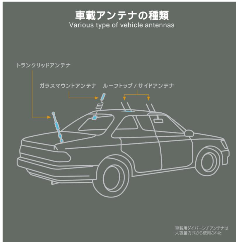
**車載アンテナの各種構造**
